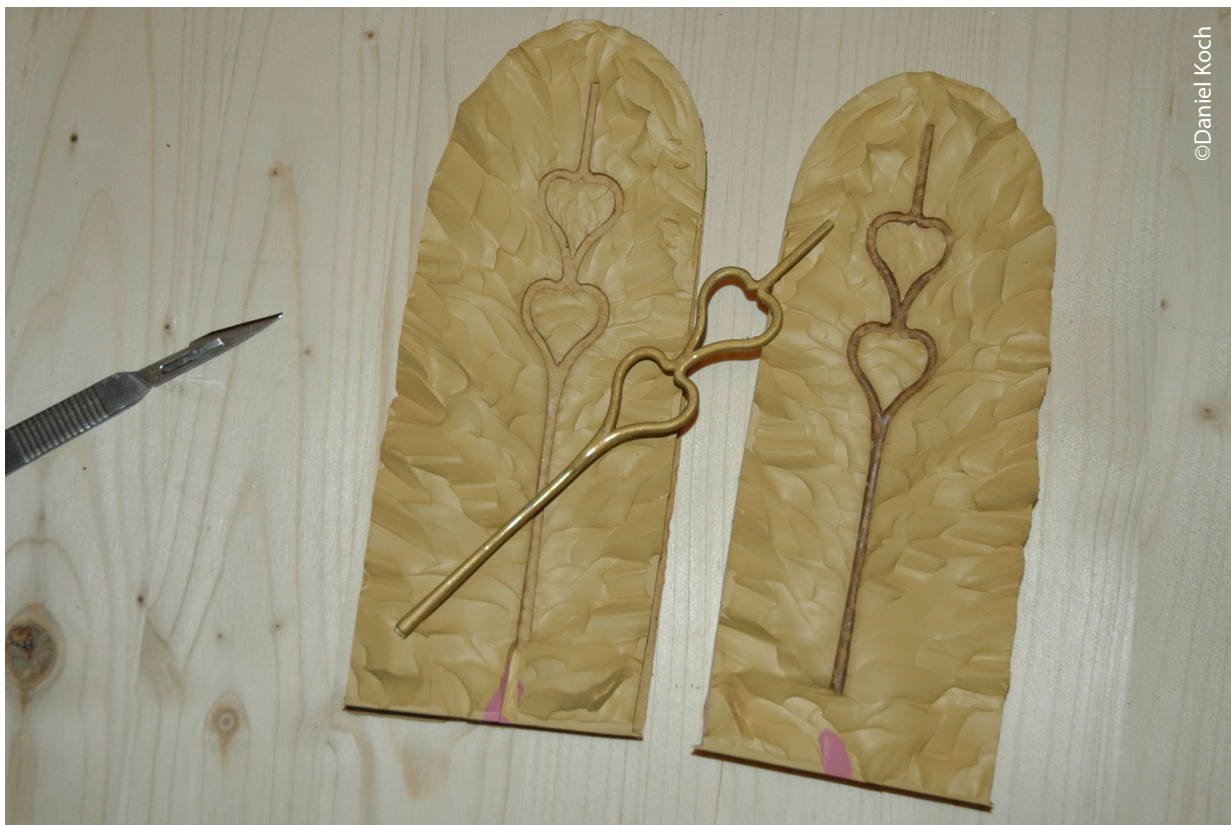
Réalisation du moule pour la coupe métallique.
