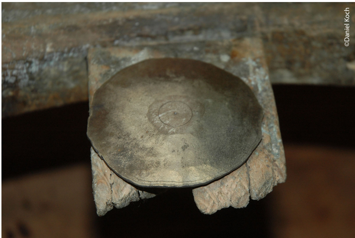
Mise en forme et martelage du pied.
