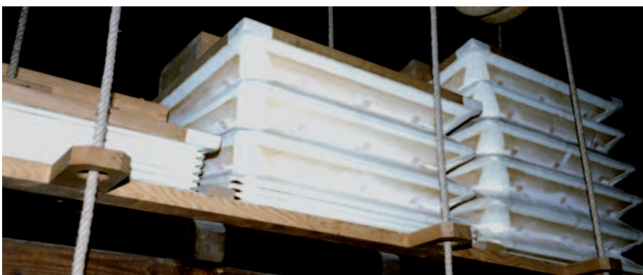
Les 3 soufflets cunéiformes ouverts à différentes hauteurs
