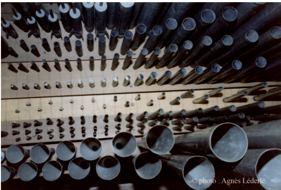
Tuyauterie du Grand-orgue. De bas en haut : Trompette (basse et dessus), Fourniture 3 rangs, Sifflet (basse et dessus), Tierce, Doublette, Nazard, Bourdon.
