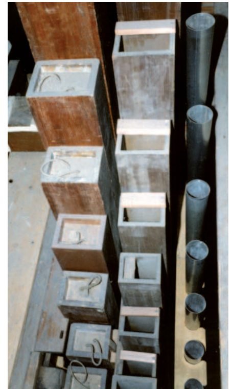
Tuyauterie de la Pédale. De gauche à droite : Soubasse, Octavebasse, Trompette.
